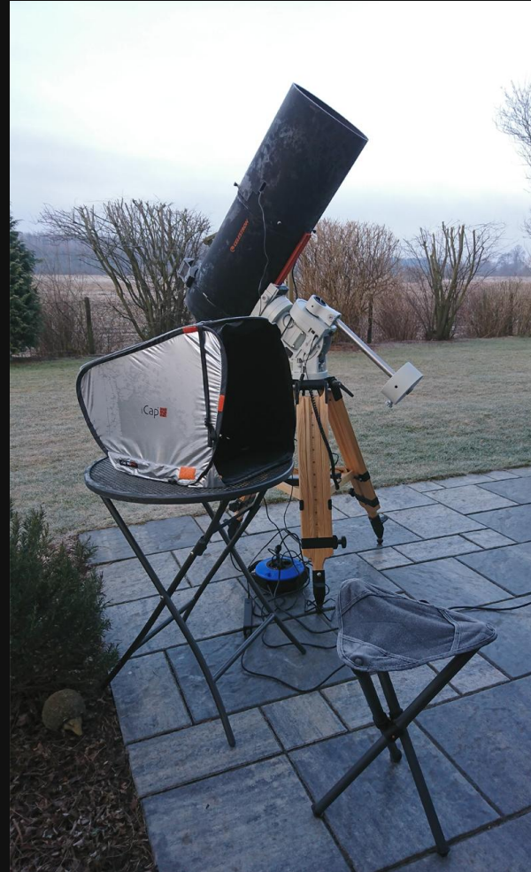
Celestron C11 mit Taukappe und Laptopschutz iCap
