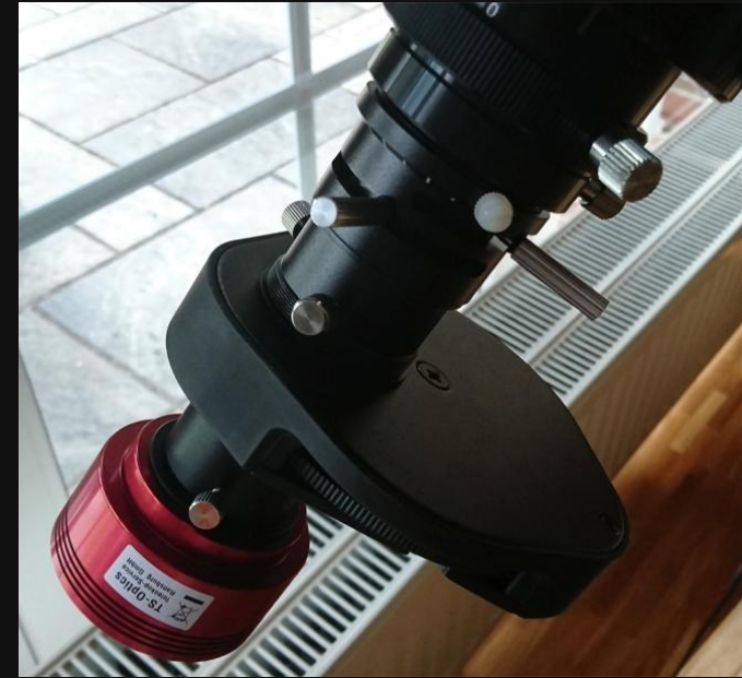
ZWO Atmospheric Dispersion Korrektor (ADC) mit A.S.I. 178MM-Kamera und Filterrad
